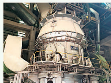
02 máy nghiền liệu năng suất 320 t/h 02 Raw Meal capacity 320 t/h
