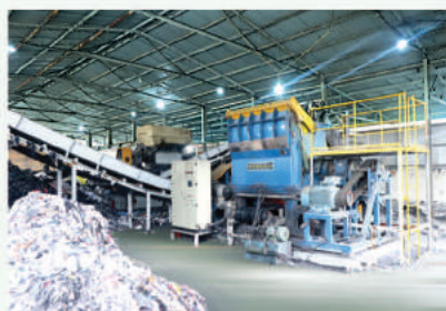
Máy cắt tinh năng suất 4-6 t/h Fine cutting machine with capacity 4-6 t/h
