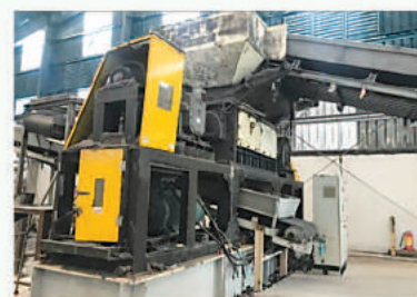
Máy cắt thô năng suất 5-7 t/h Coarse cutting machine capacity 5-7 t/h
